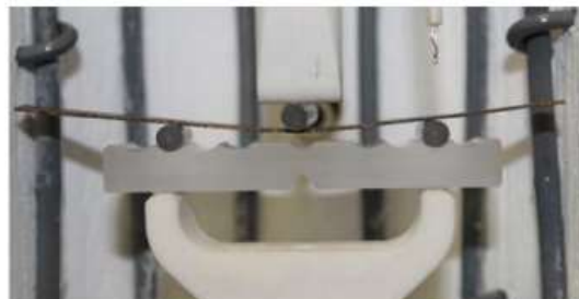
Fig3. ジンバル型マウントのプッシュロッドと ローラーサポート
