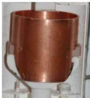
Fig2. 銅製 熱保護シールド (950℃対応)
