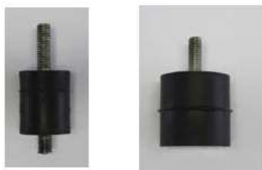
Fig1. 円筒状防振ゴムサンプル（2 通り）
